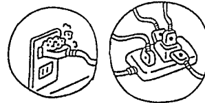
ほこりをためない たこ足配線しない
